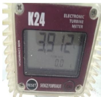
Gambar 4.1 Hasil Uji Coba Laju Aliran Air Pada Pipa Pen Stock 1
