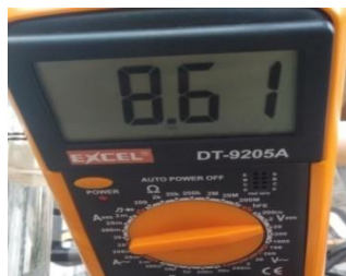
Gambar 4.3 Hasil Uji Coba Tegangan Listrik Pada Pipa Pen Stock 1
