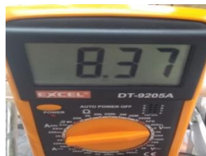
Gambar 4.4 Hasil Uji Coba Tegangan Listrik Pada Pipa Pen Stock 2
