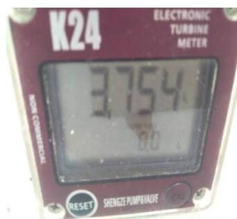
Gambar 4.2 Hasil Uji Coba Laju Aliran Air Pada Pipa Pen Stock 2
